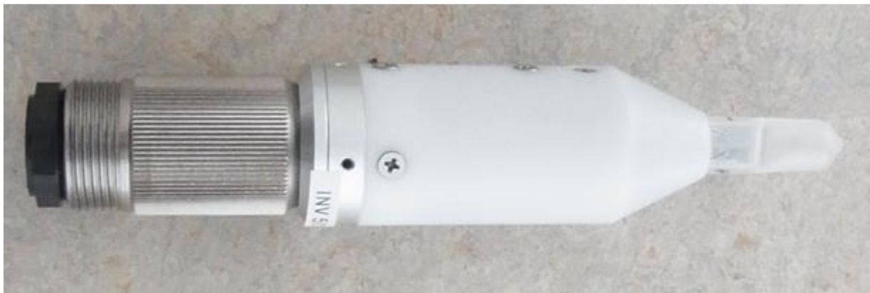
Abbildung 6.3: Spektrale Strahlungsleistungsnormallampe, Osram 64602, 12V, 50W mit passendem Messadapter für die Montage in der Ulbrichtkugel
