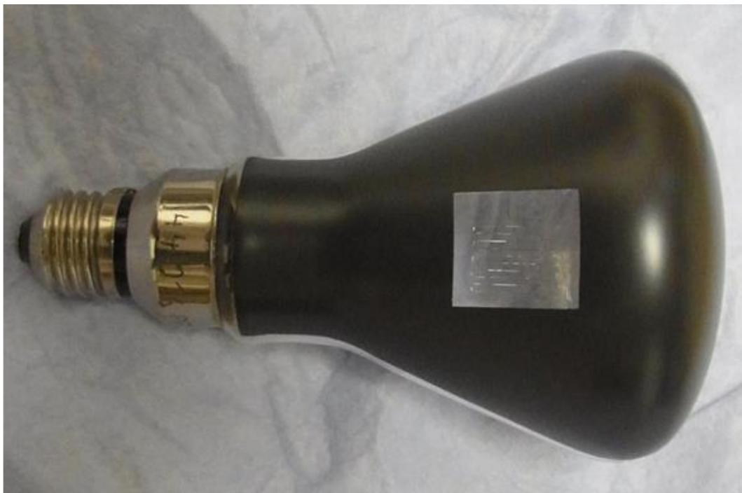
Abbildung 6.5: Lichtstärkenormallampe Wi41-G zur Kalibrierung des Drehspiegelgoniophotometers
