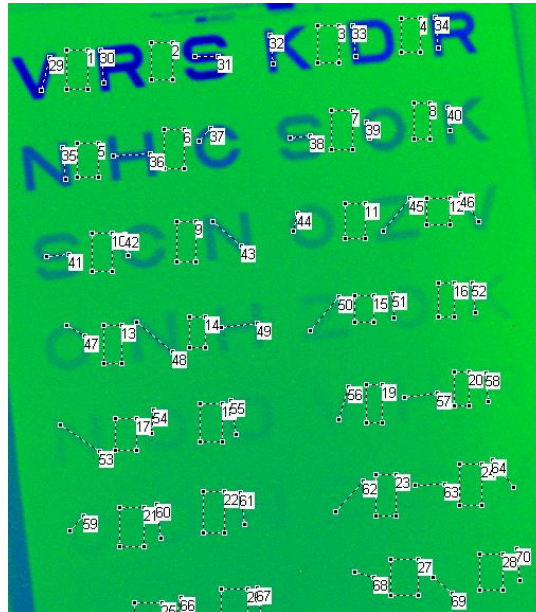
Abbildung 4.30: Leuchtdichteaufnahme der verwendeten Pelli-Robson-Tafel
