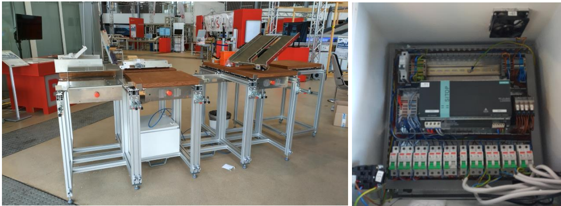
Abbildung 19: Einbau der zentralen Stromversorgung und Ausstattung der Modulplätze
