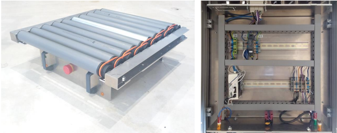
Abbildung 17: Umsetzung eines Fördermoduls und seiner Steuerung
