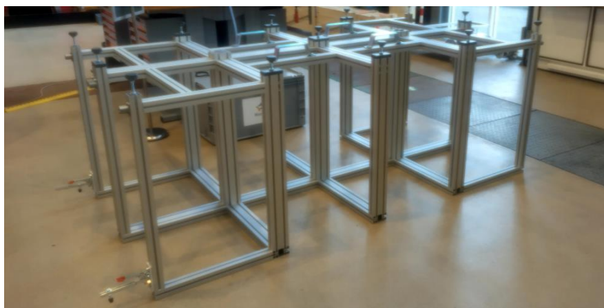
Abbildung 18: Zusammenbau des Rahmens. Hier noch in der Konfiguration mit seitlichem Moduleinschub.
