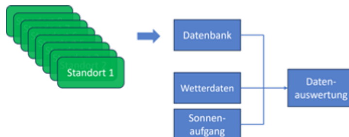
Abbildung 10: Übersicht der Datenstruktur mit acht Standorten, die die Daten in die Datenbank schreiben, die zusätzlich erhobenen Wetter- und Sonnenaufgangsdaten, die zur Datenauswertung genutzt werden.
