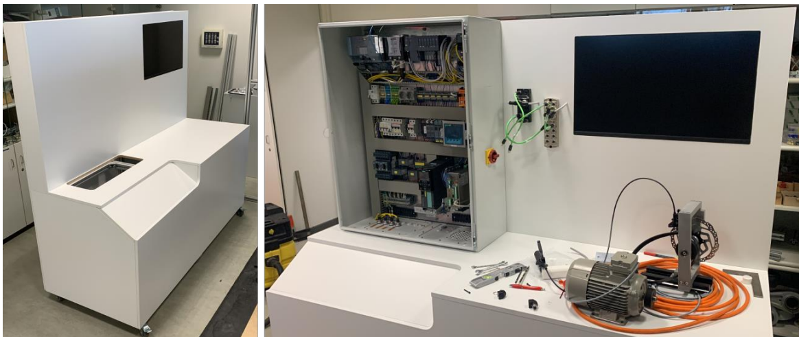
Abbildung 27 Verkleidetes Demonstrator-Gestell (links) und Befestigung erster Komponenten am Demonstrator (rechts)
